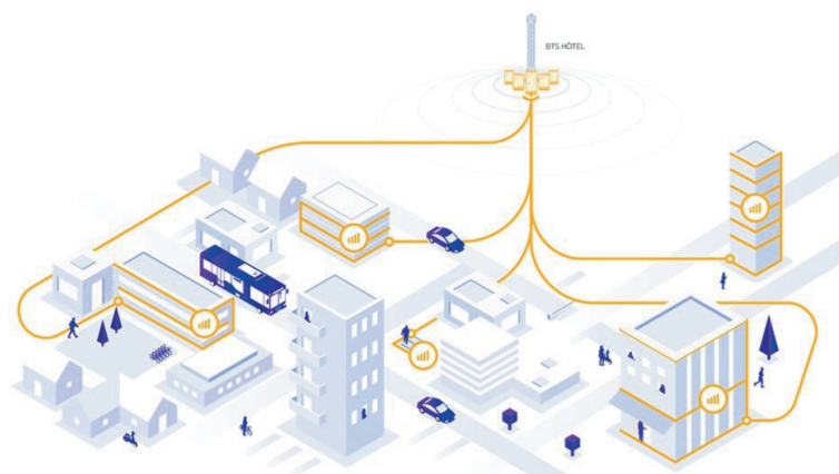
Schéma du BTS Hôtel : architecture antennaire mutualisée.
